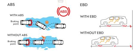
ANTI-LOCK BRAKING SYSTEM (ABS) WITH ELECTRONIC BRAKE DISTRIBUTION (EBD) AND BRAKE ASSIST (BA)
